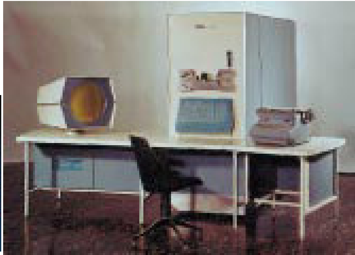
DEC presenta la PDP-1, primera computadora comercial con monitor y teclado que funcionaba a transistores
